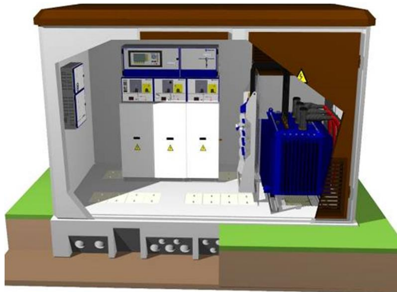
Ilustración 4.3. Esquema de un Centro de Transformación Automatizado (Aguirre Valparis, Amezua Ayarza, & Sánchez, 2017)
