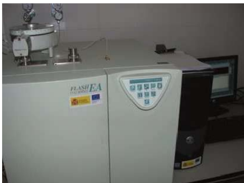
Figura 8.- Analizador elemental modelo Flash EA1112 CHNS-O
