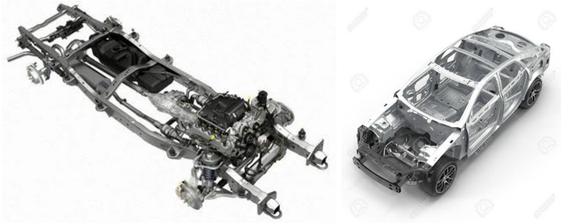
Figura 2.1. Chasis integral de un camión y chasis autoportante de un turismo. De izq. a dcha.
