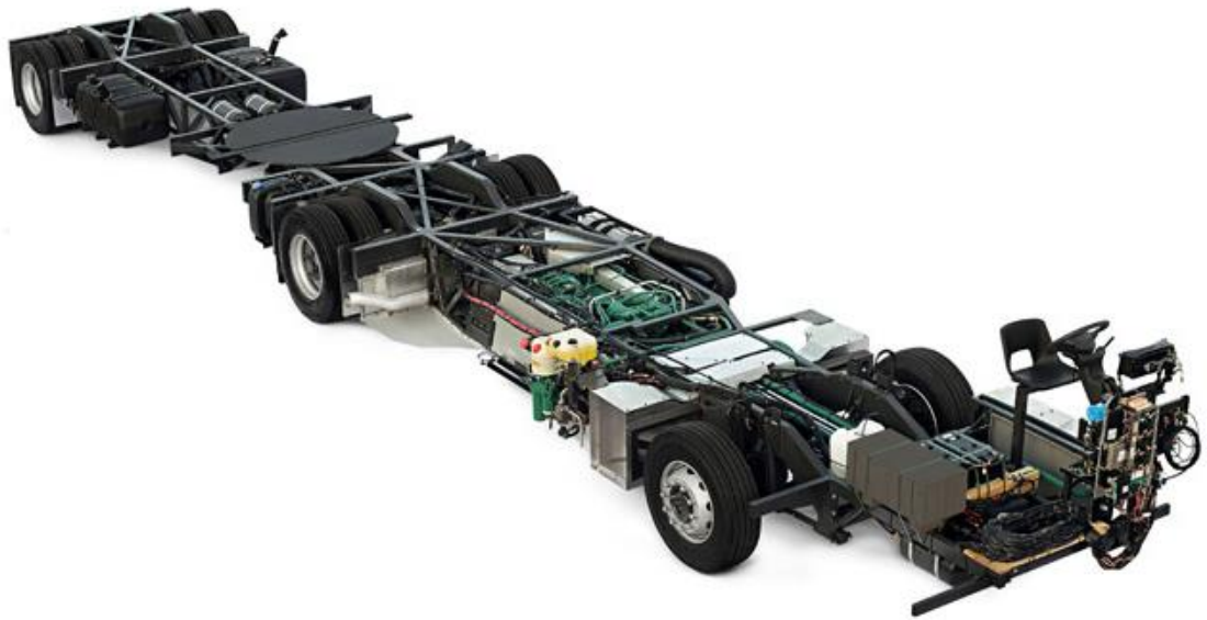
Figura 2.2. Chasis integral de un autobús articulado.
