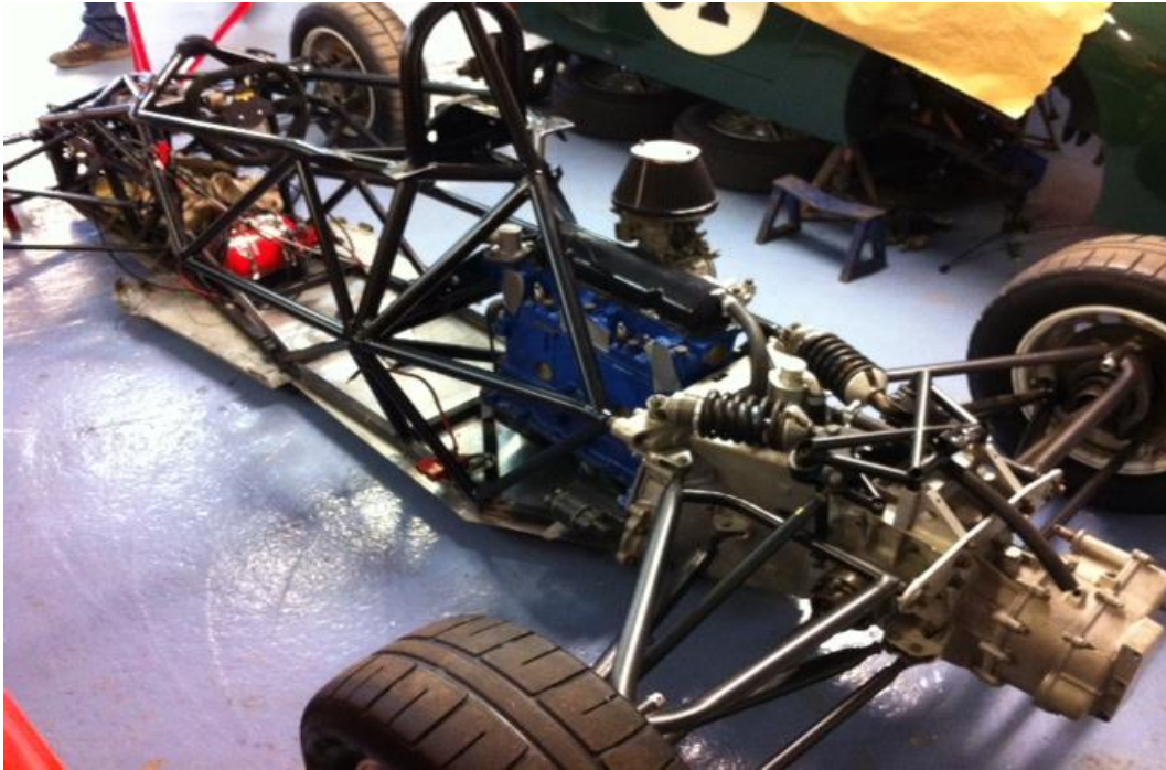
Figura 2.3. Chasis tubular de un Formula Ford anterior a 2015.
