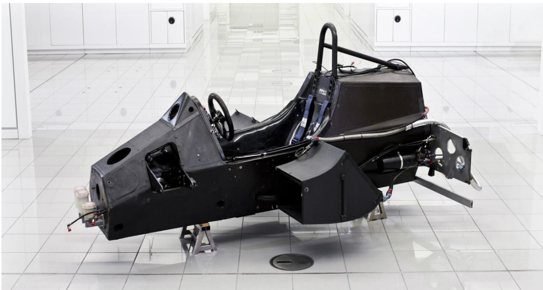
Figura 2.4. Chasis monocasco del McLaren MP4/1.
