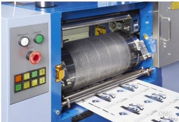
Ilustración 1. Impresión offset rotativa.
