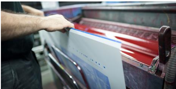
Ilustración 2. Impresión offset en pliego.
