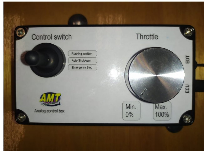
(b) Posición intermedia (2) permite la parada del motor.
