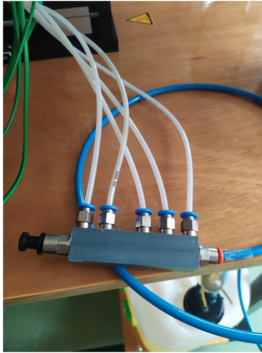
Figura 4.22: Elemento de unión de los tubos al manómetro
