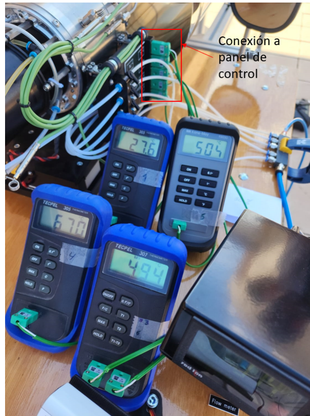
Figura 1.7: Conexión termómetro al panel de sensores
