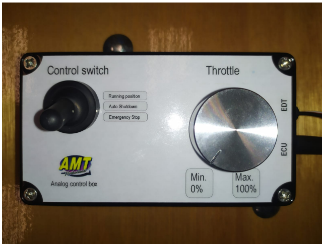
(a) Posición inferior (1) permite la parada de emergencia.
