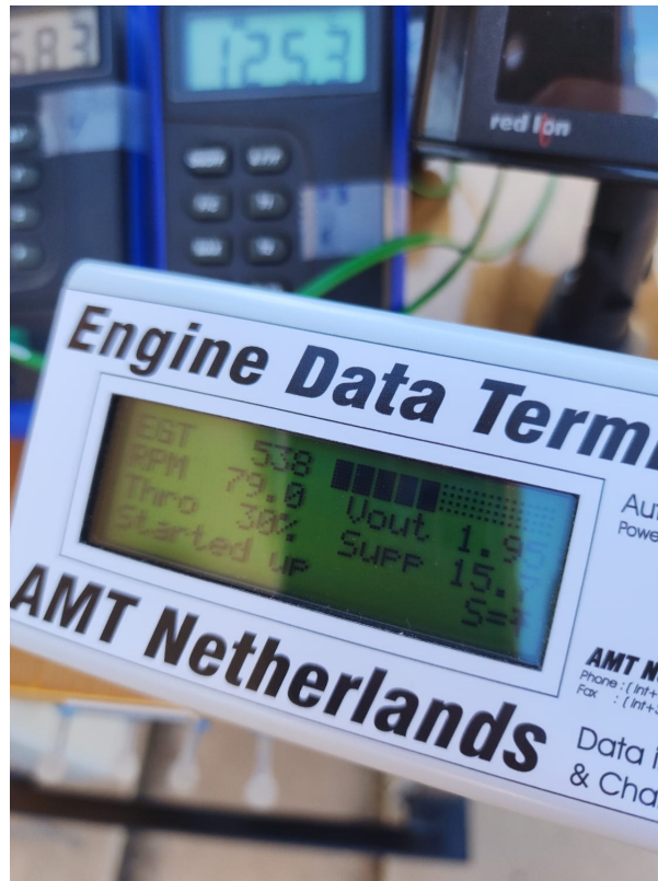
Figura 4.19: Mediciones del EDT para un grado de carga de 30 %
