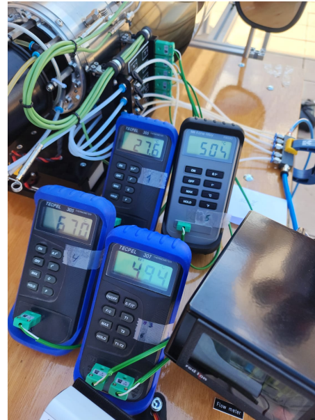
(b) Mediciones de temperaturas con modelo 307 en la posición 6
