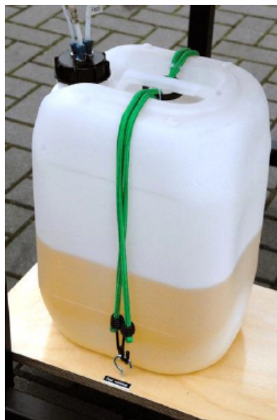
Figura 3.26: Depósito de combustible del banco de ensayo
