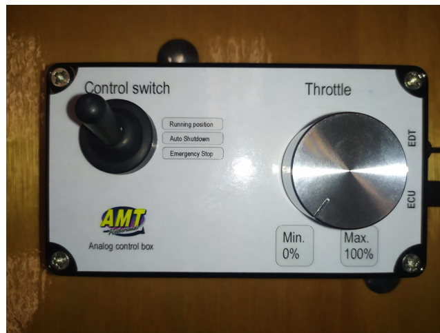
(c) Posición superior (3) permite el encendido del motor.
