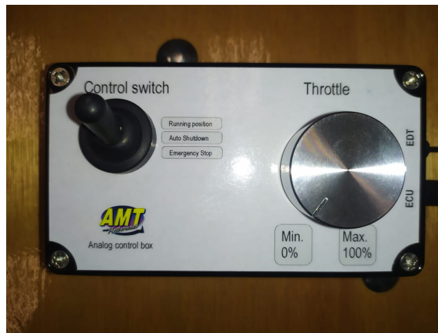
(c) Posición superior (3) permite el encendido del motor.
