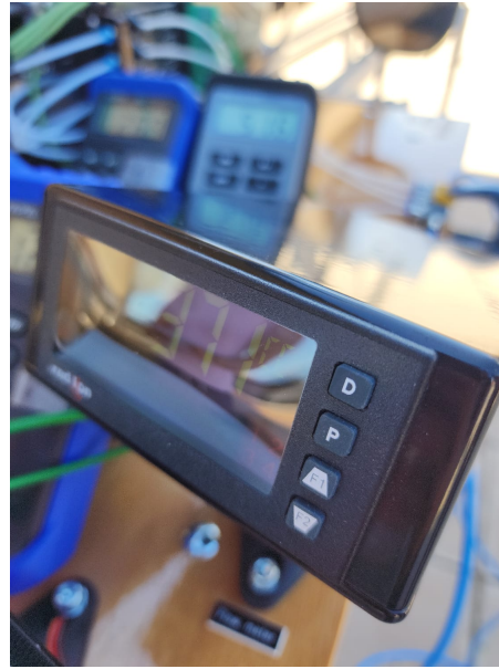
(b) Medición del consumo de combustible total en \text{cm}^3/\text{min}
