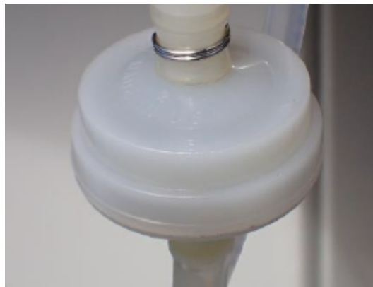
Figura 3.28: Filtro de combustible del depósito
