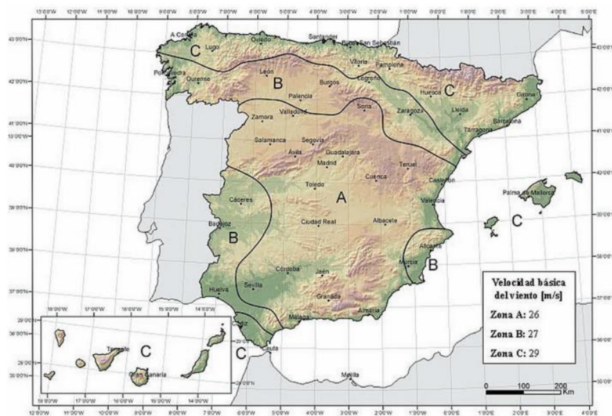
Figura 3.1. Mapa de isotacas para la obtención de la velocidad básica fundamental del viento v_{b,0}
