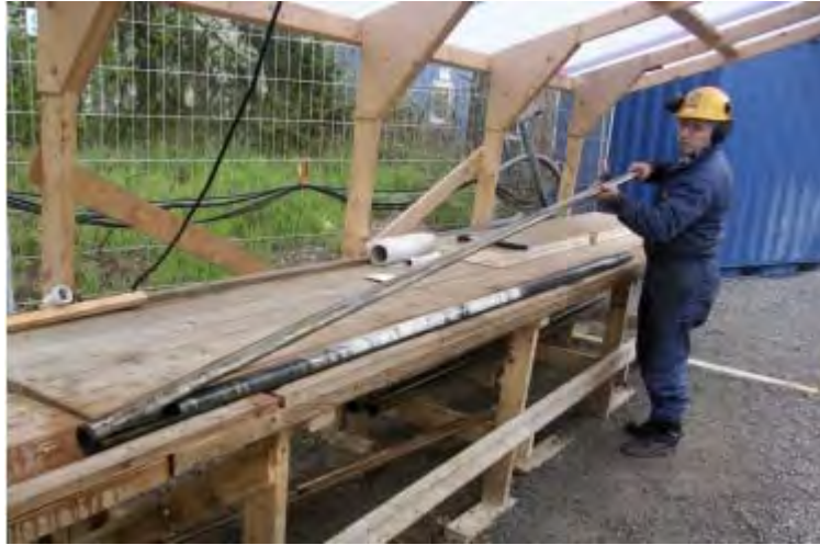
Figura 12. Operación de extracción de testigo
