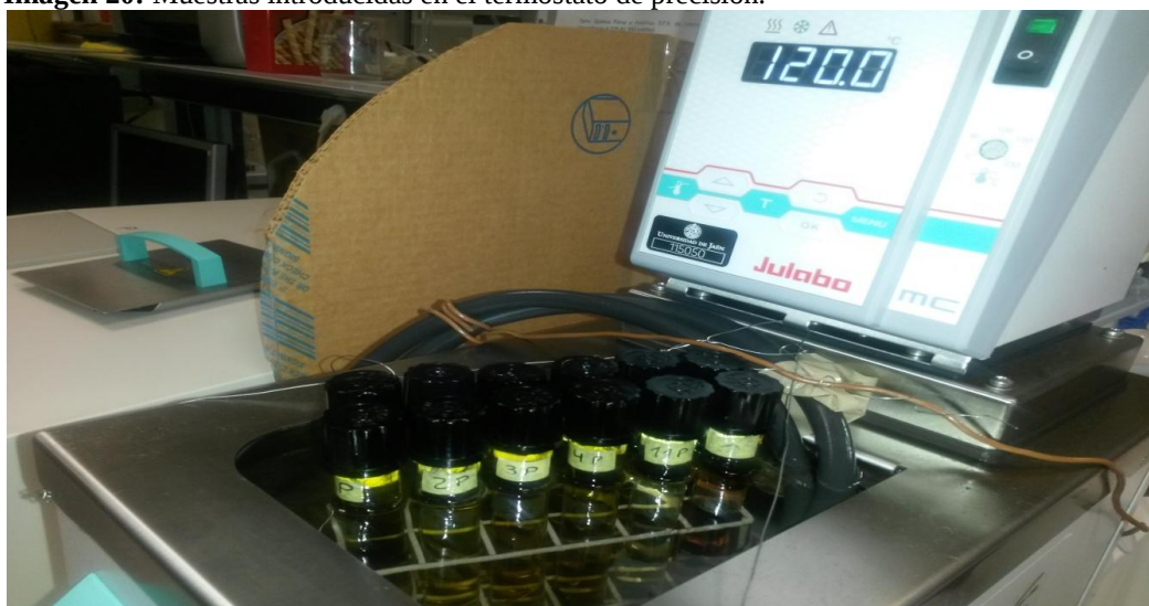
Imagen 20: Muestras introducidas en el termostato de precisión.
