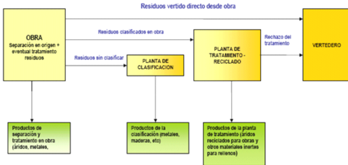
Figura 59. Gestión de residuos de construcción y demolición
