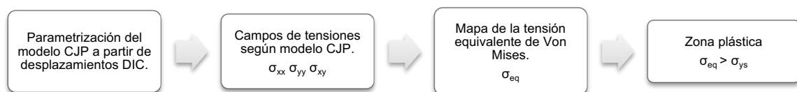
Esquema 2. Cálculo de la zona plástica a partir de los campos de tensiones estimados por el modelo CJP.
