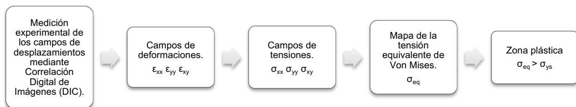
Esquema 1. Cálculo de la zona plástica a partir de los campos de tensiones experimentales DIC.
