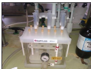
Figura 4. 16. Columnas SPE dispuestas en bomba de vacío.
