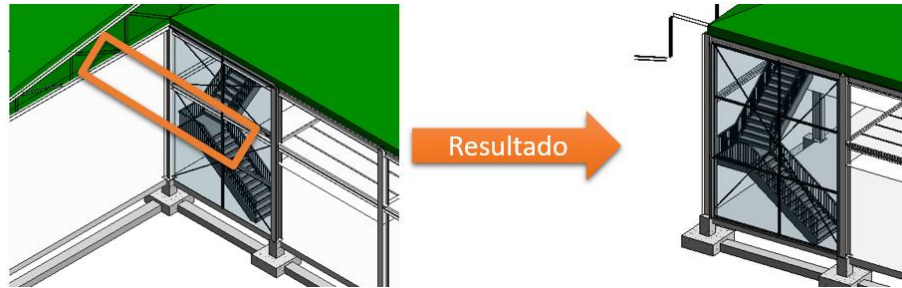
Ilustración 157. Resolución de la interferencia constructiva. Fuente: elaboración propia
