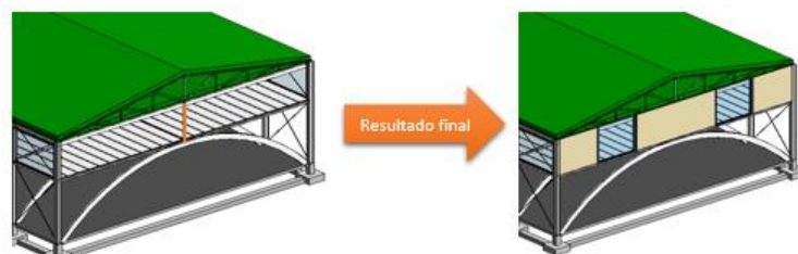
Ilustración 160. Inserción de la columna y resultado de los muros en la fachada frontal. Fuente: elaboración propia
