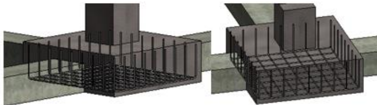
Ilustración 59. Resultado final de la propuesta para la armadura en zapata. Fuente: elaboración propia
