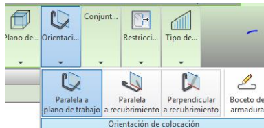
Ilustración 55. Plano de inserción de la armadura.
