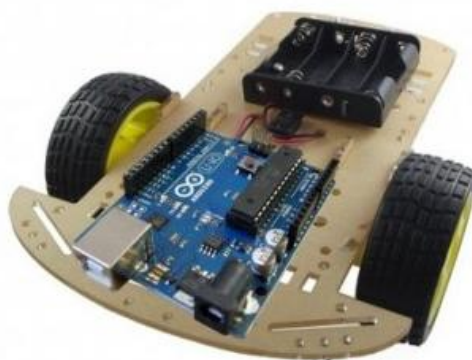
Figura 4.2 Coche Teledirigido con Arduino
