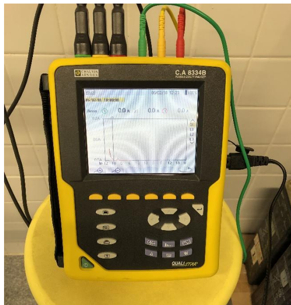
Figura 4.13- Analizador de redes. Fuente propia.
