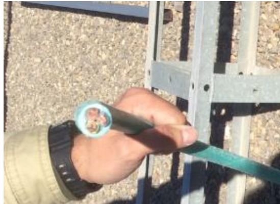
Figura 4.14- Sección manguera alógena. Fuente propia.
