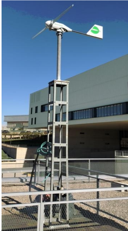
Figura 4.8-Aerogenerador fijado en su estructura. Fuente propia.
