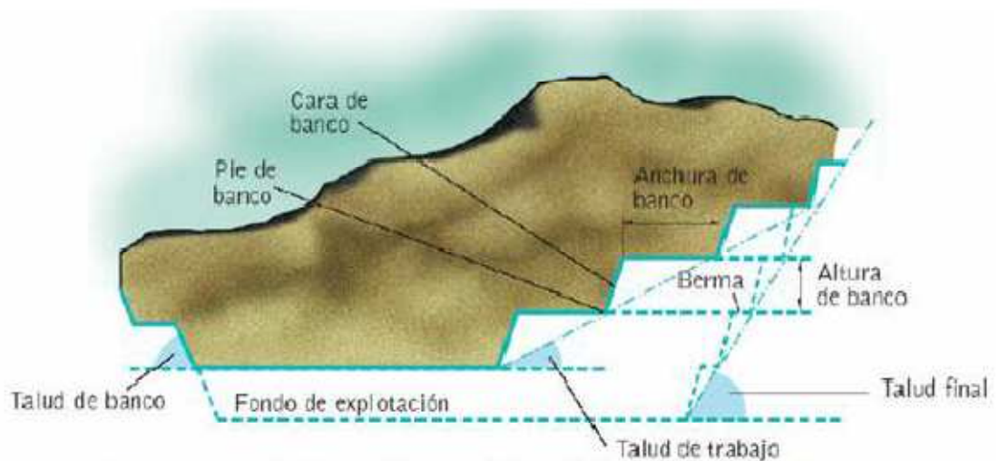
FIG 1.4 Esquema general de una explotación mediante bancos descendentes.
