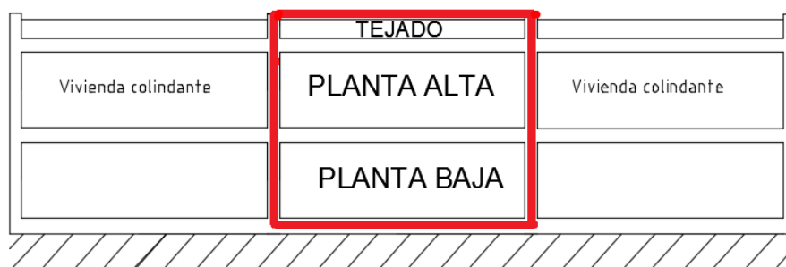
Figura 5.6 Esquema de la sección longitudinal de la envolvente térmica.
