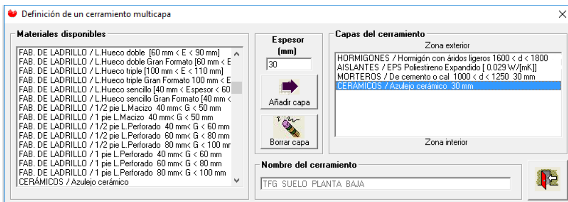
Figura 6.3 Ejemplo de introducción del cerramiento de cimentación en el programa Calculair
