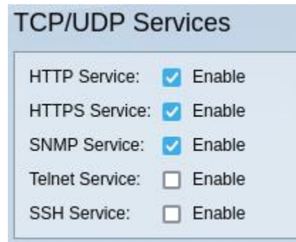
Figura 30: Servicio SNMP activado en el Switch
