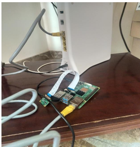
Figura 64. Conexión Raspberry al router
