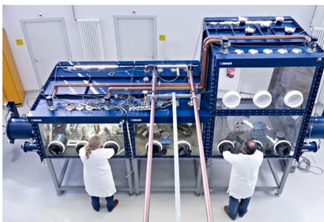
Figura 20 Confinamiento del proceso
