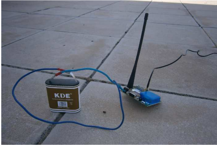
Figura 4.18: uBlox Base con batería externa
