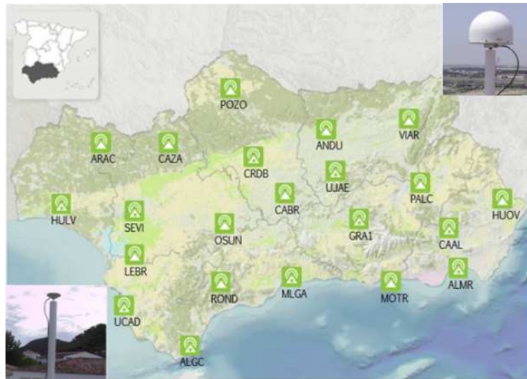
Figura 3.5: Despliegue territorial de las 22 antenas de la Red Andaluza de Posicionamiento
