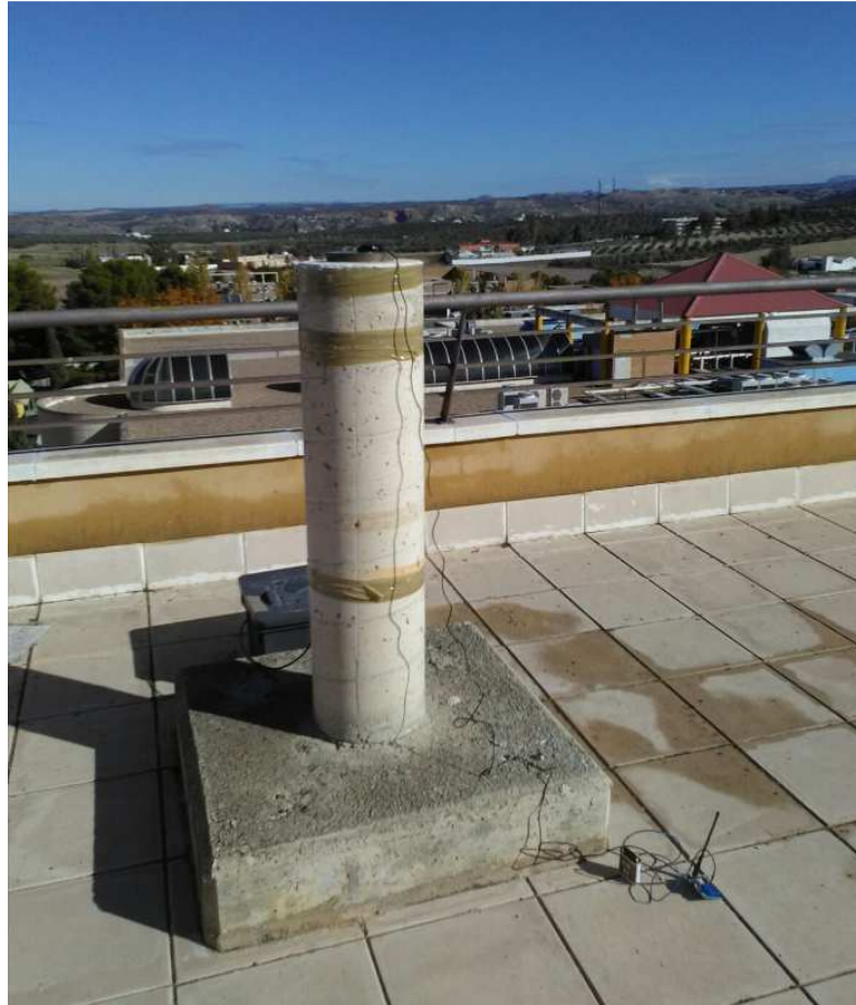
Figura 6.5: Pilar 2, uBlox de referencia
