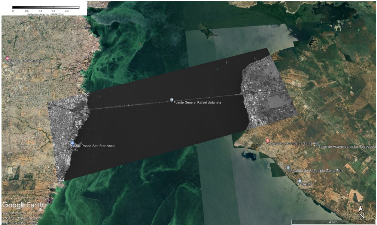
Figura 61. Mapa de reflectividad Puente General Rafael Urdaneta, sobre el Lago de Maracaibo en dirección ascendente.
