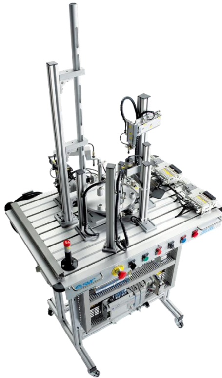
Figura 16 Estación FMS-204. Inserción de ejes
