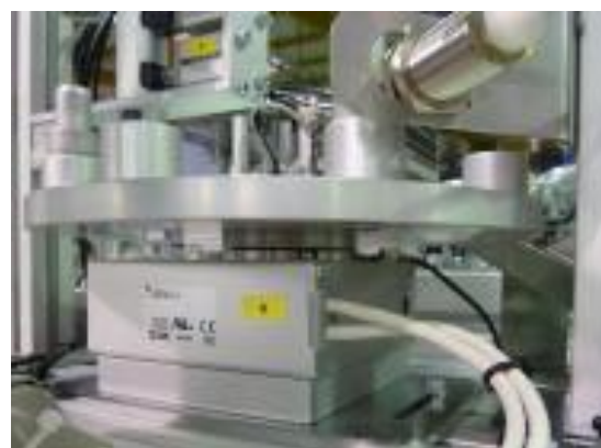
Figura 18 Servomotor para el giro del plato
