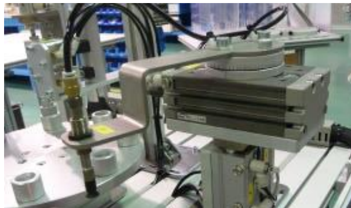
Figura 25 Manipulador rotolineal para inserción de eje
