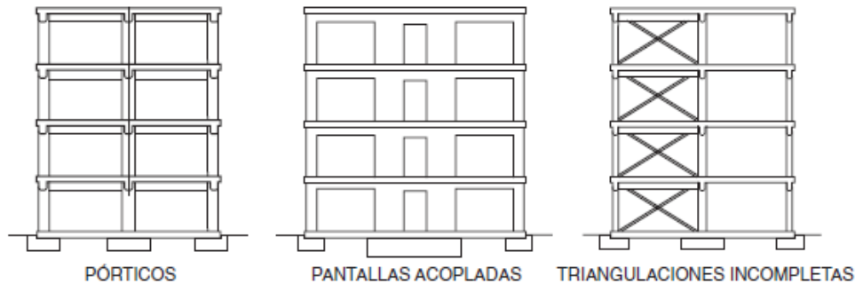
Figura 2. Ejemplos de organizaciones estructurales que permiten un valor del coeficiente de comportamiento por ductilidad \mu = 4 . (Fuente: NCSE – 02)
