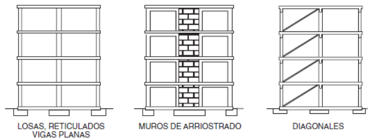
Figura 4. Ejemplos de organizaciones estructurales que permiten un valor del coeficiente de comportamiento por ductilidad \mu = 2 . (Fuente: NCSE: 02)
