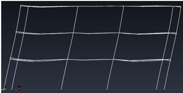
Figura 44. Deformación de la estructura para el empuje incremental en X (a) y en Y (b), (GiD).
