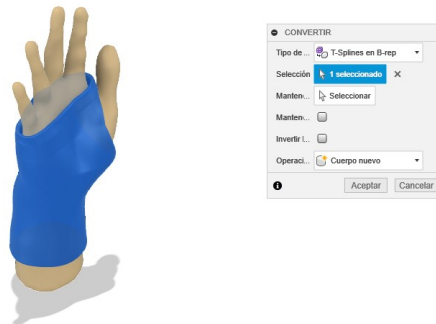
figura 41: conversión de malla a sólido
