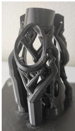
figura 99: parte izquierda a la espera de ser despegada de la cama de impresión y recibir posprocesado
