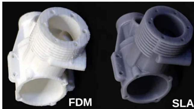
figura 12: comparación del acabado superficial
