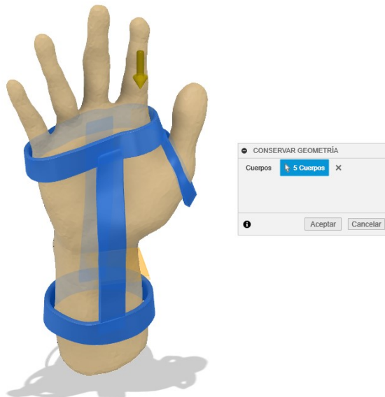
figura 71: selección de la geometría de conservación
