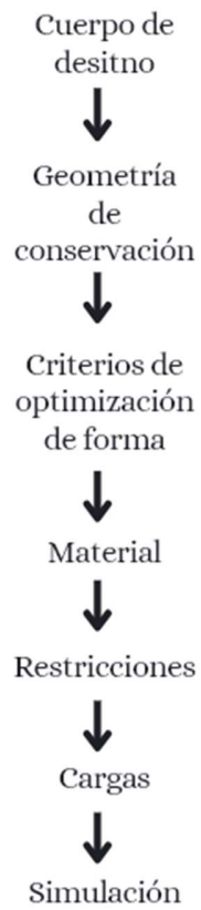
Ilustración 9: diagrama de la optimización topológica
