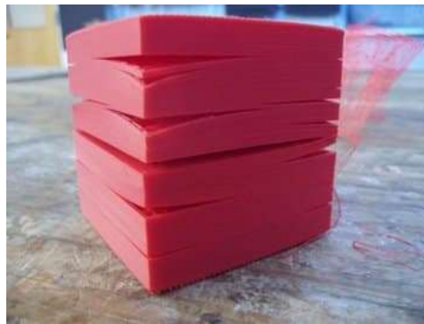
figura 91: pieza impresa en 3D sufriendo delaminación
