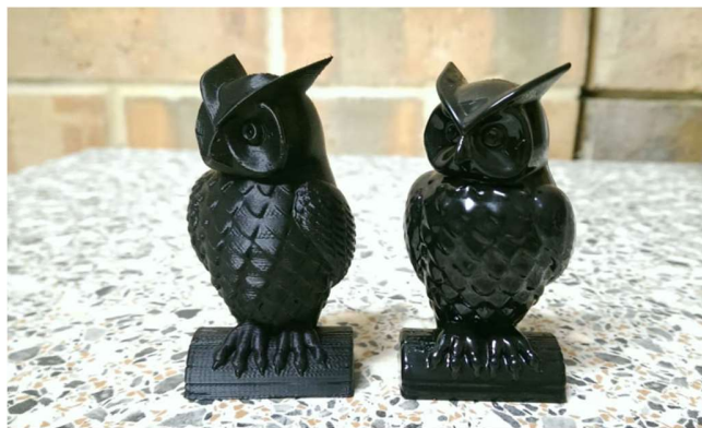
figura 11: comparación de PLA (izquierda) frente a ABS con acetona (derecha)
