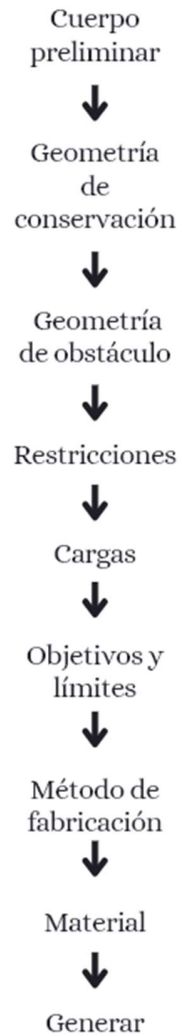
Ilustración 10: diagrama del diseño generativo
