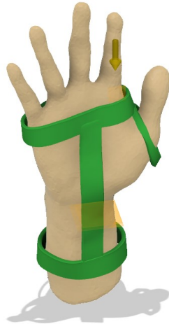
figura 72: la geometría de conservación es representada en color verde
