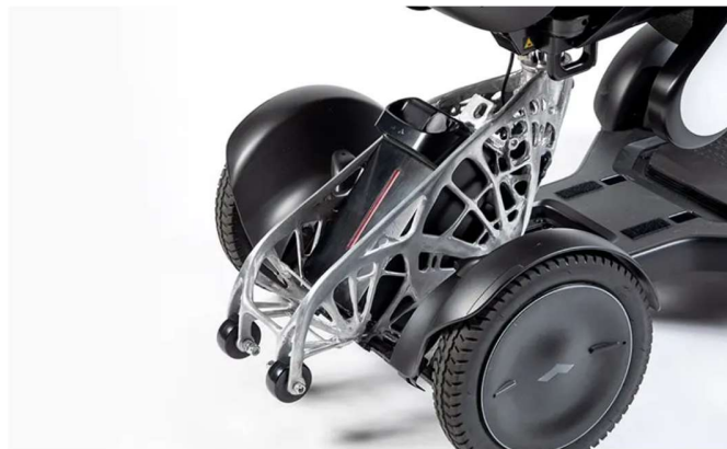
figura 67: bastidor de batería de un vehículo de movilidad personal por diseño generativo
