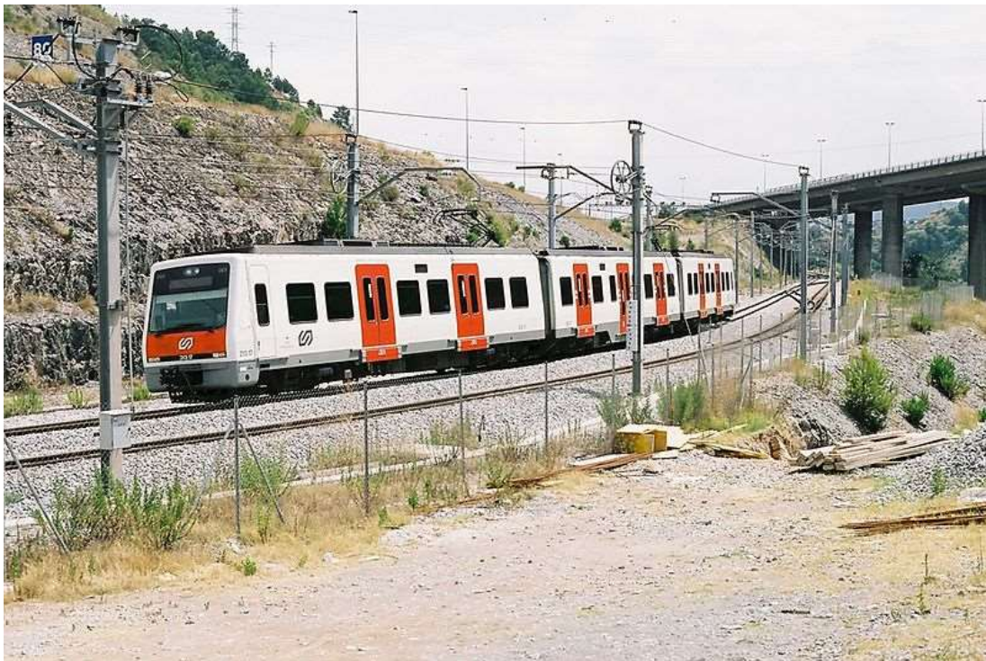
Ilustración 1. Unidad ferroviaria ejemplo. Serie 213 FGC. 2 automotores y 1 remolque
