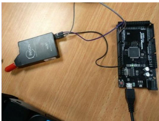
Figura 4.24. Alimentación placa Arduino y Micro NIR.
