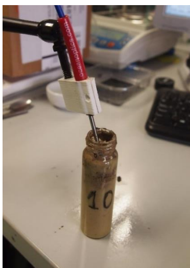
Figura 5.4. Sonda de medida en probeta
