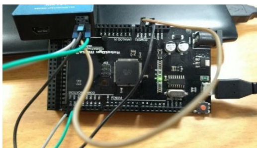
Figura 4.26. Conexión placa Arduino y equipo NIR
