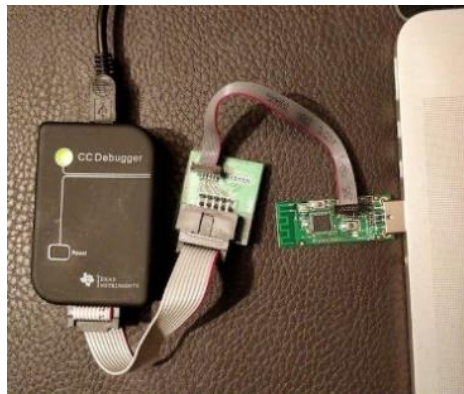
Figura 4.34. Conexión entre el programador y dispositivo CC2531.
