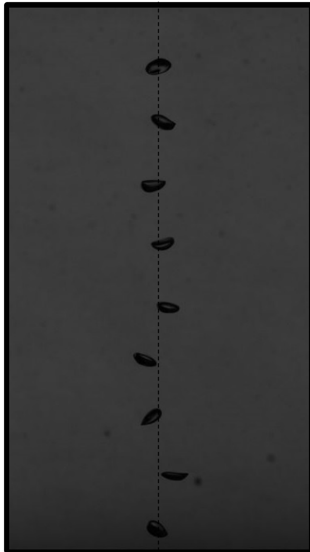
FIGURA 36: AVANCE DE UNA BURBUJA GENERADA POR UNA AGUJA DE 2 MM Y UN PASO TEMPORAL DE 0,05 s (GA=302,31, Bo=0,597).
