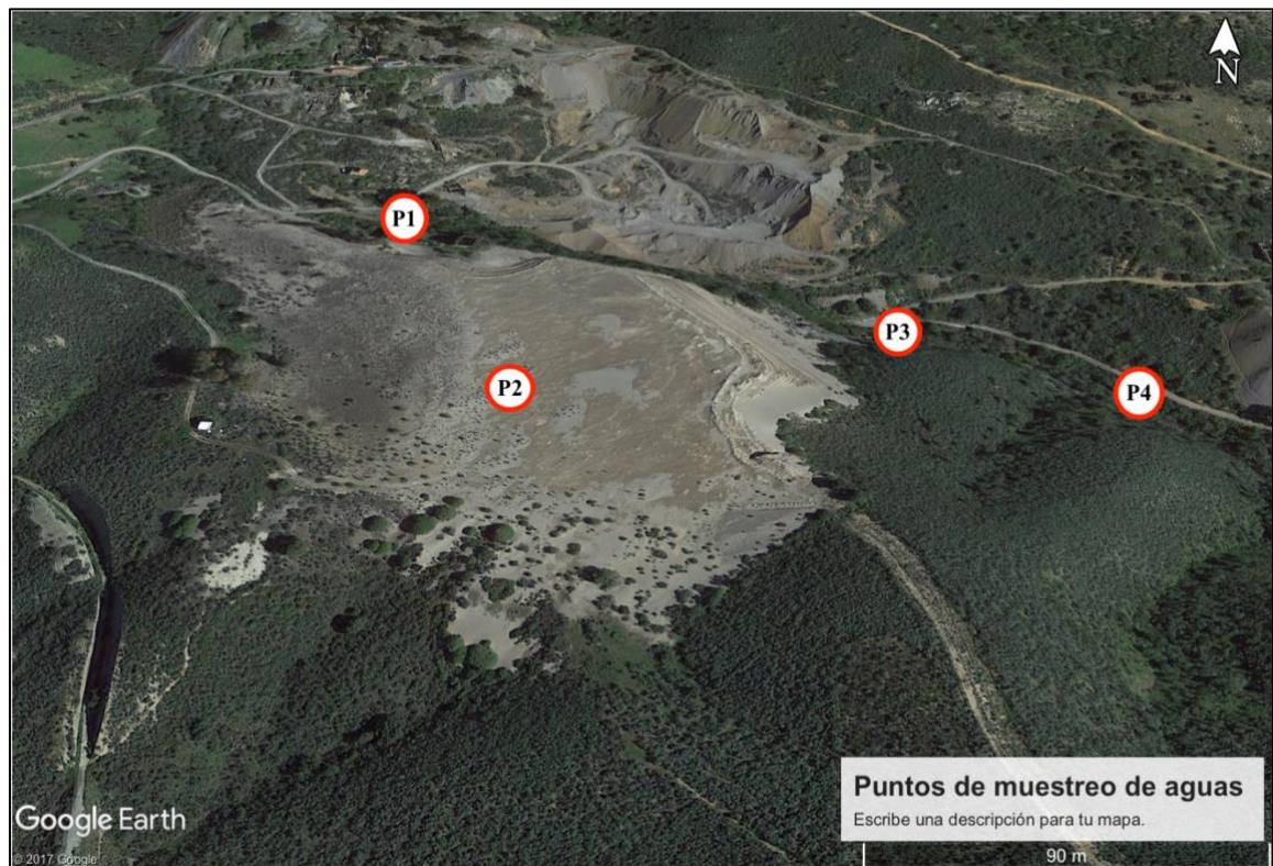
Figura 22: Localización de los puntos de muestreo de agua respecto a la presa de lodos de La Manzana, (Google Earth).
