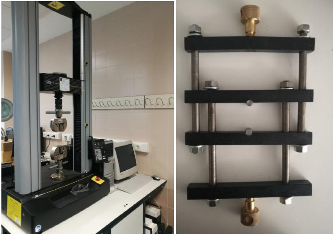
Figura 24- Máquina de tracción INSTRON y accesorio para obtener compresión diametral.
