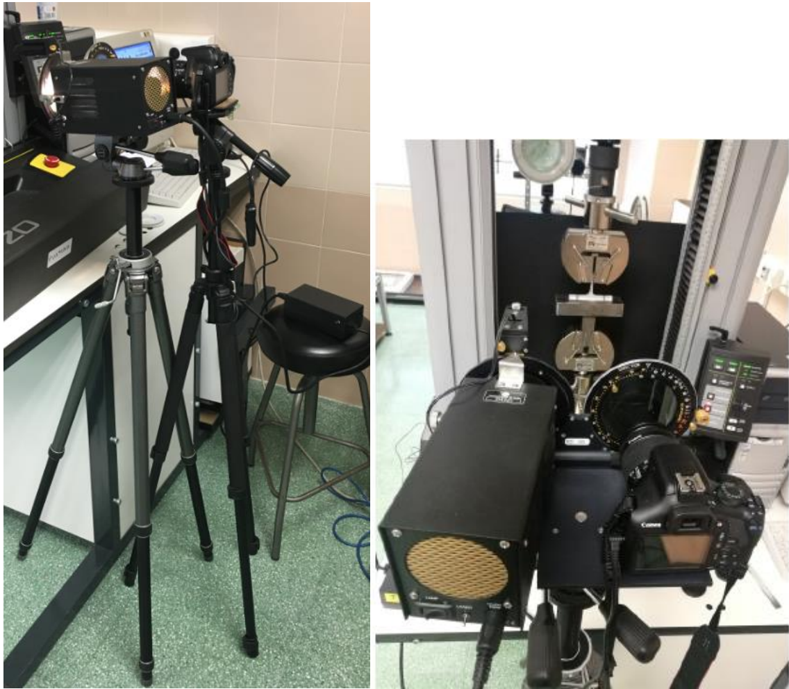
Figura 28- Montaje del polariscopio a reflexión.
