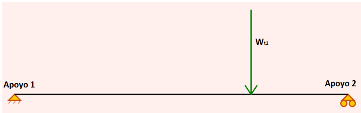
Ilustración 2.16.- Representación de las fuerzas sobre el eje de salida en el plano XZ.
