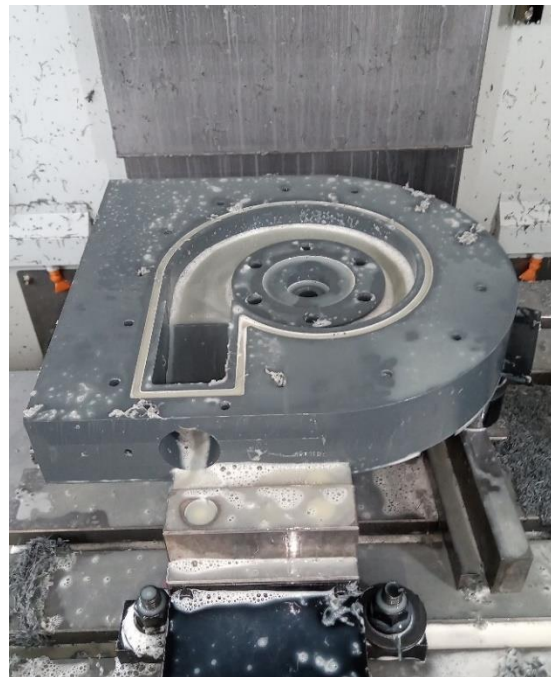
Fig. 61. Cámara espiral tras la mecanización.
