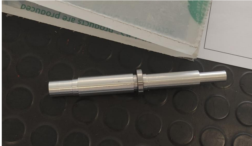
Fig. 74. Eje principal mecanizado.
