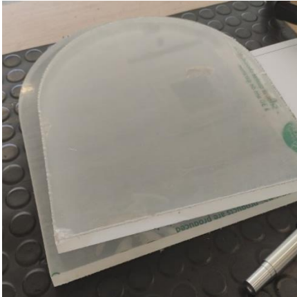
Fig. 63. Tapa de metacrilato en bruto con contornos exteriores.
