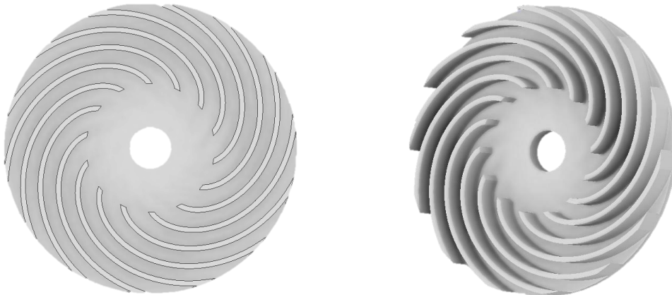
Fig. 33. Diseño 3D del rodete en el software Autodesk Inventor 2022.
