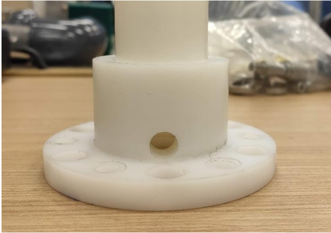
Fig. 76. Acoplamiento de la polea a la carcasa mecanizado.
