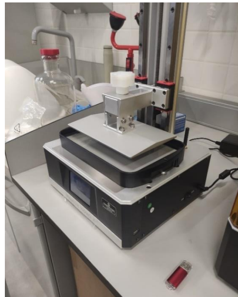
Fig. 54. Calibrado de la base en Impresora 3D.
