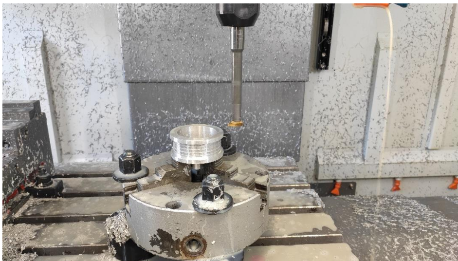
Fig. 67. Mecanizado por control numérico de la polea de freno.
