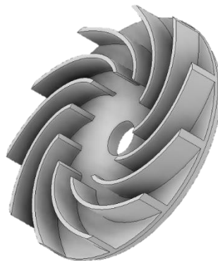
Fig. 81. Rotor con \beta_1 igual a 35° y 11 álabes.
