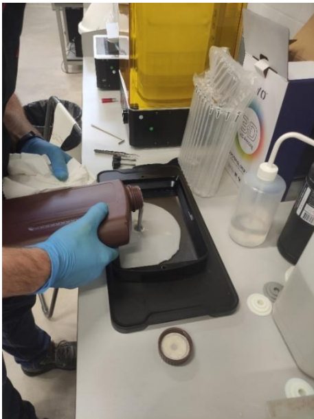
Fig. 55. Vertido de resina en bandeja de Impresora 3D.
