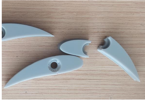
Fig. 83. Rotura de álabes debido al material.
