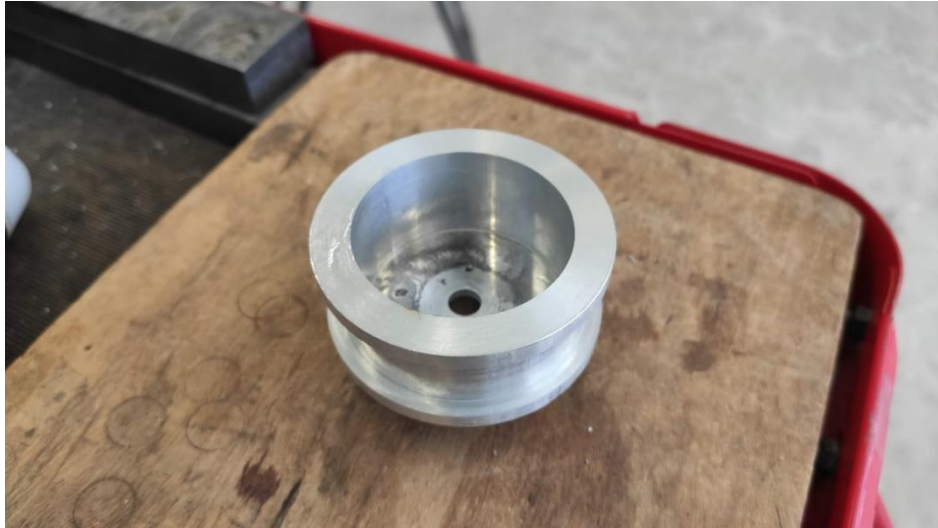
Fig. 68. Polea de freno mecanizada.
