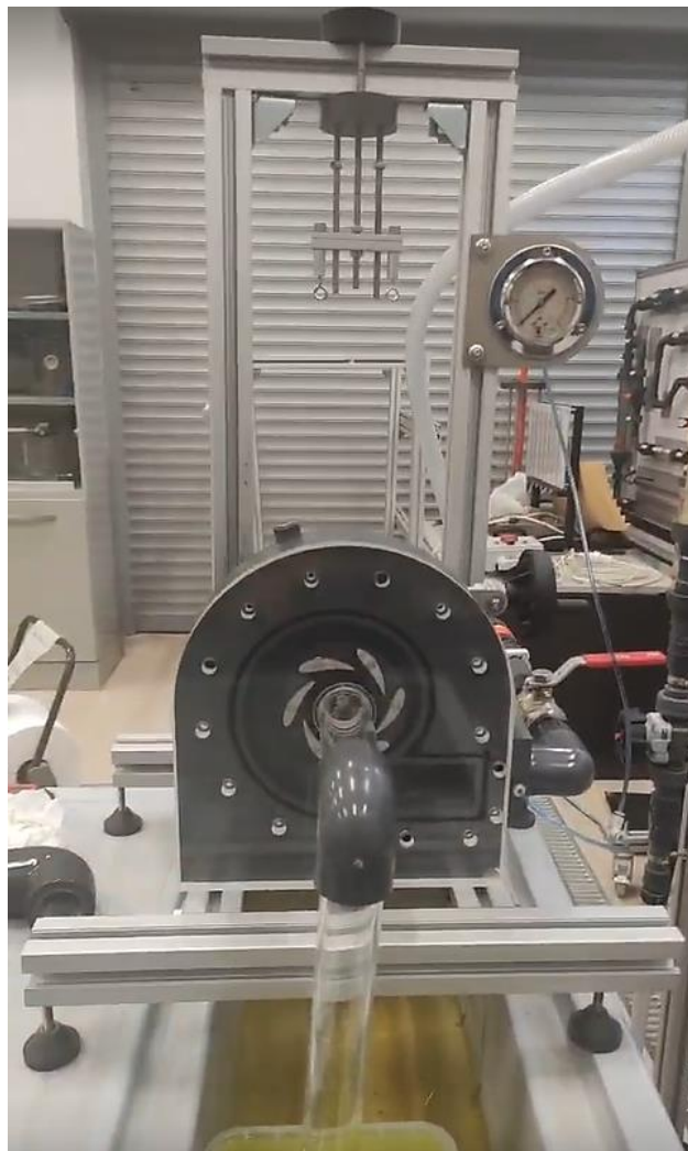
Fig. 79. Ensamblaje de la Turbina Francis.
