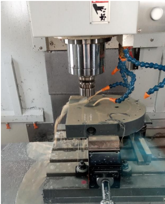
Fig. 62. Mecanizado de la cámara espiral.
