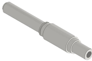
Fig. 48. Diseño de eje principal de la Turbina Francis en Inventor.
