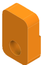
Fig. 71. Tope de sujeción anillo distribuidor.
