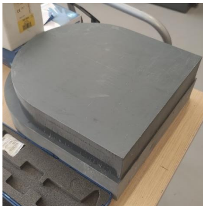
Fig. 60. Carcasa en bruto con contornos exteriores.
