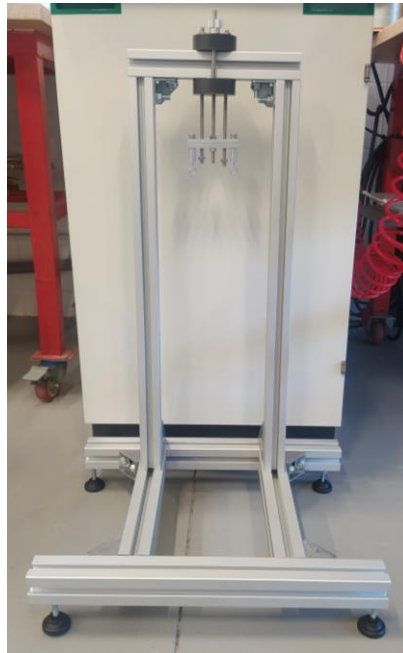
Fig. 78. Bastidor de la Turbina Francis.
