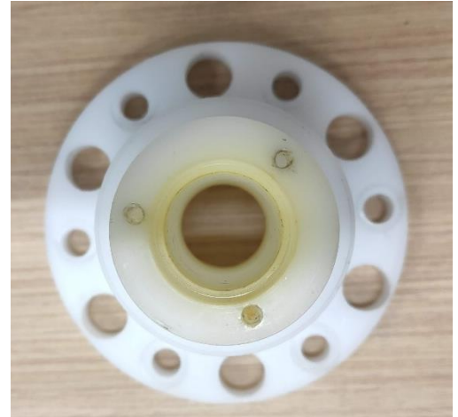
Fig. 76. Acoplamiento de la polea a la carcasa mecanizado.
