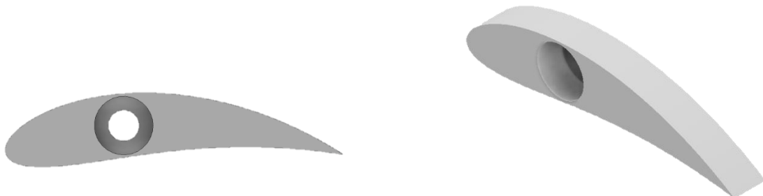
Fig. 34. Diseño 3D del álabe directriz NACA 9612.
