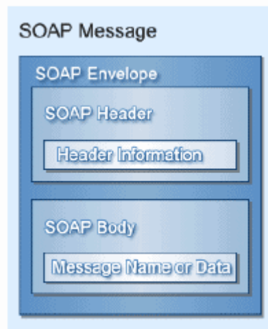
Imagen 2.1.1.2. Estructura de un mensaje SOAP.
