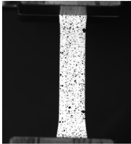
Ilustración 16- Imagen DIC del ensayo de tracción
