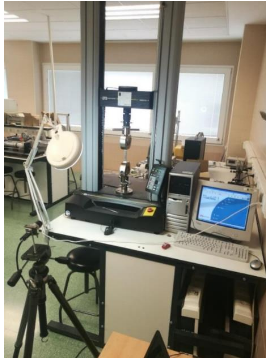
Ilustración 30- Montaje del ensayo de tracción
