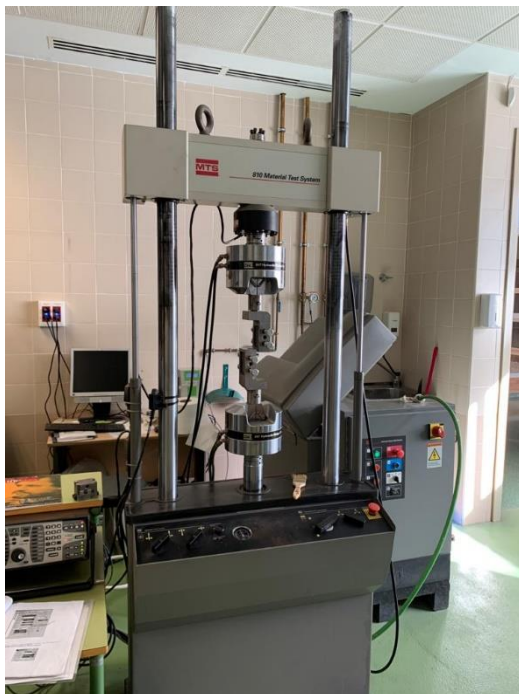
Ilustración 32- Máquina usada para el ensayo de cortante (izquierda) y mordazas (derecha)
