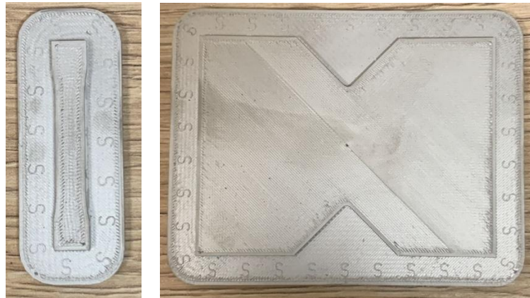
Ilustración 26- Resultado final del proceso completo de fabricación de las probetas
