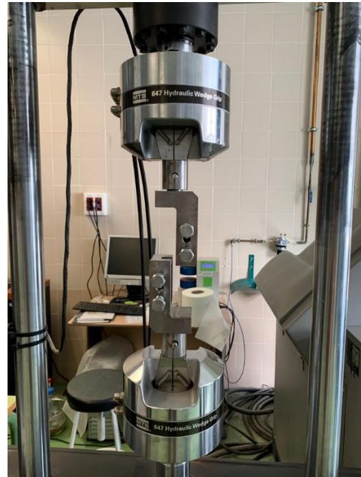
Ilustración 32- Máquina usada para el ensayo de cortante (izquierda) y mordazas (derecha)
