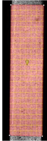
Ilustración 35- Configuración del mallado en VIC 2D
