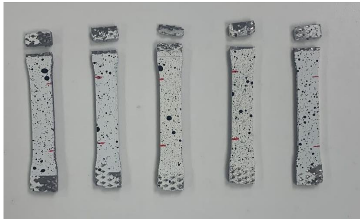
Ilustración 47- Fractura de las probetas impresas en la dirección Y
