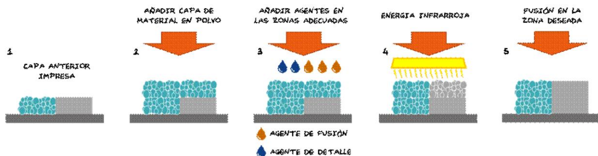
Ilustración 13- Funcionamiento de la tecnología MJF [5]
