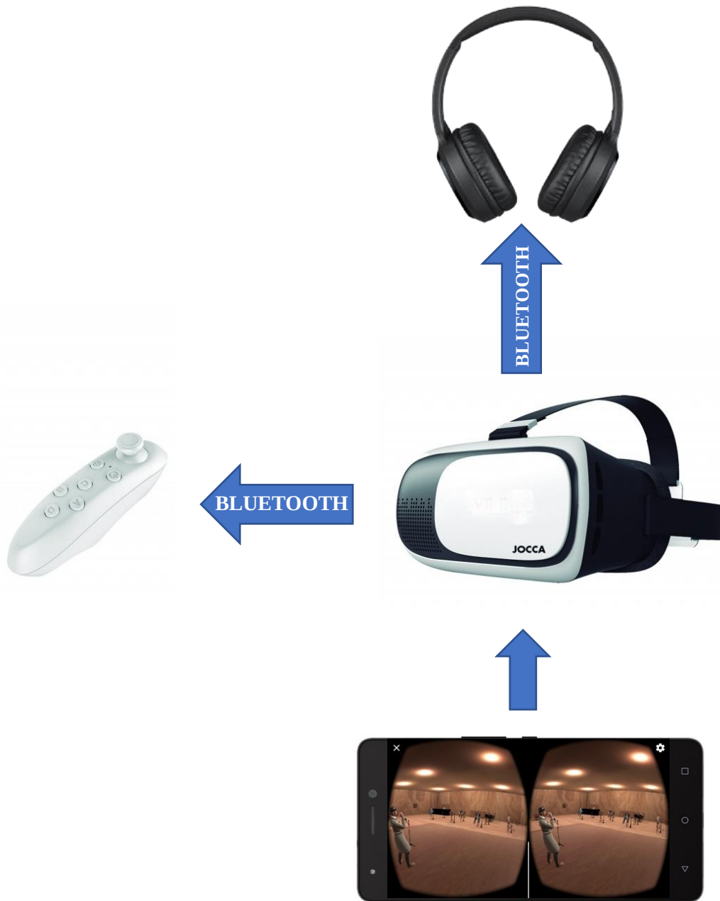
Figura 43: Esquema del sistema VR
