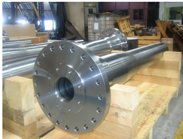
Ilustración 17.- Eje primario del aerogenerador (ALSTOM).
