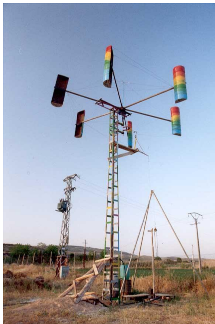
Ilustración 28.- Aerogenerador vertical de tipo Panémona (www.OPEXenergy.com).
