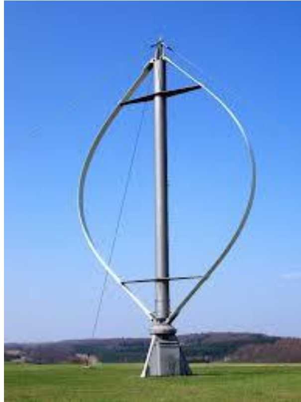
Ilustración 26.- Aerogenerador vertical de tipo Darrieus (www.OPEXenergy.com).
