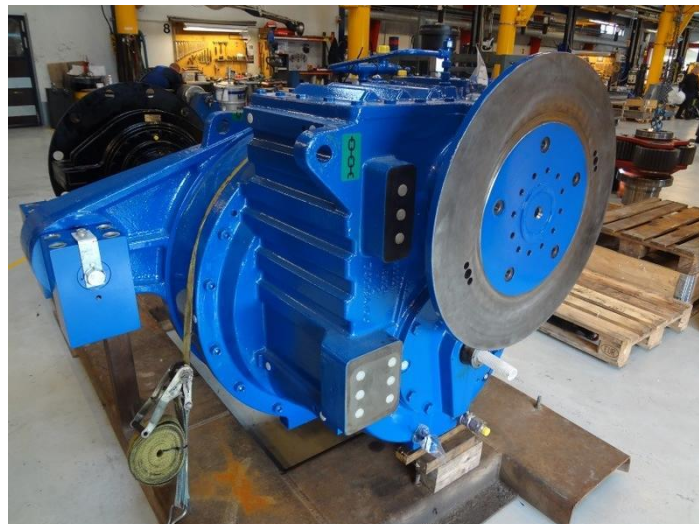
Ilustración 14.- Multiplicadora del aerogenerador (www.winergy.com).
