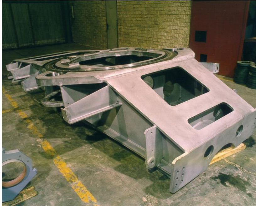
Ilustración 19.- Bastidor mecánico del aerogenerador (ALSTOM).
