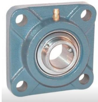
Figura 4.21. Soporte autoalineante cuadrado en fundición gris con inserto ya montado, tipo UCF205 para eje de \phi 25 mm del catálogo Mano a mano
