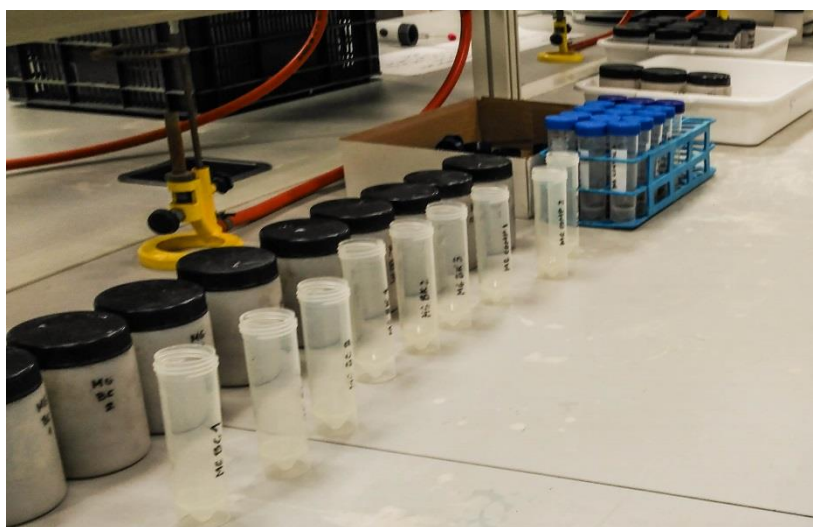
Figura 15. Proceso extracción con KCl
