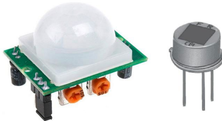
Figura 8: A la izquierda, sensor PIR y a su derecha, un sensor piroeléctrico
