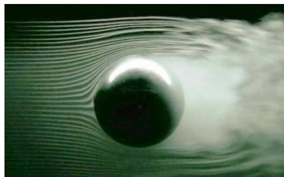
Figura 4.9 – Ejemplo de desprendimiento de capa límite y estela
