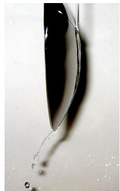
Figura 5.8. - Efecto Coanda sobre la superficie de una cuchara.
