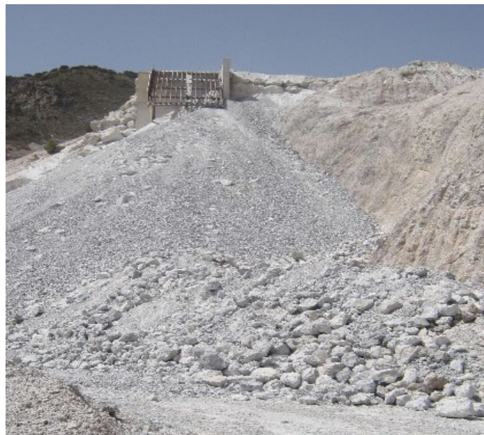
Imagen 2. Zona de acopio del “rechazo” de la zaranda > 250 mm.
