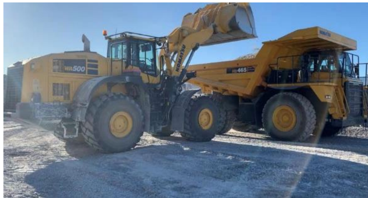
Figura 11. Pala cargadora cargando dumper.
