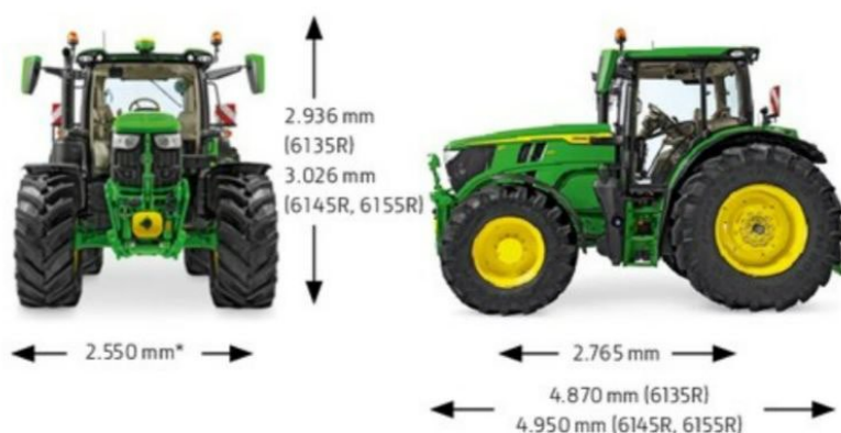
Figura 10.10. Esquema y dimensiones JOHN DEERE 6830 Premium.
