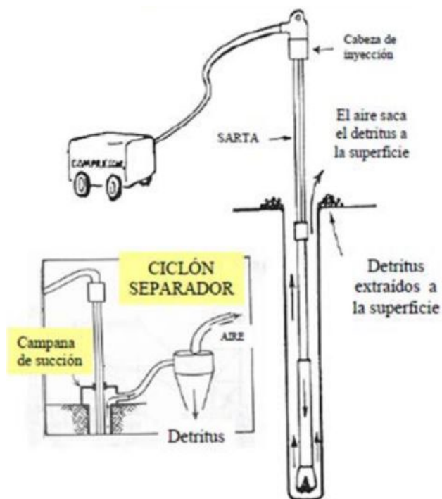
Figura 9.2. Circulación directa con aire.
