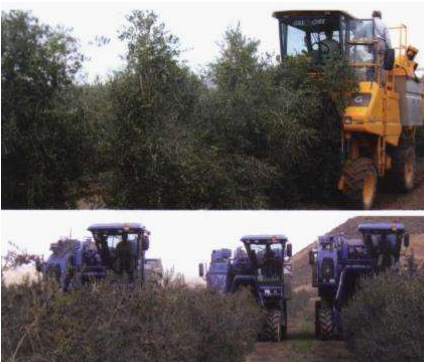
Figura 5. Cosechadoras de aceitunas (olivar superintensivo) (Blanco-Roldán, G.L. y Gil-Ribes. J.A., 2009)
