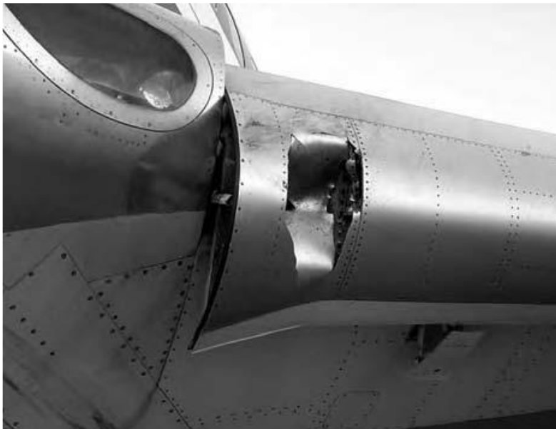
Figura 2. Fractura de la chapa de un avión
