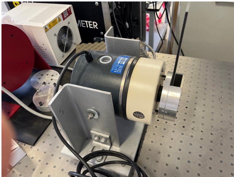
Figura 21. Excitador utilizado en el laboratorio.
