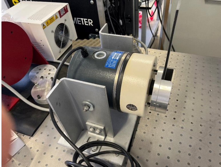
Figura 100. Excitador utilizado en el ensayo.
