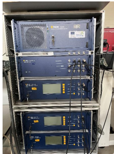
Figura 63. Front End, donde se encuentra la "Junction Box", el PC y los controladores de cada uno de los cabezales.
