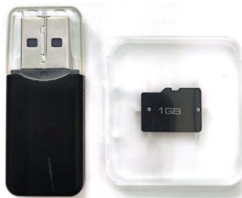
Figura 5.24. Tarjeta SD y lector de tarjeta
