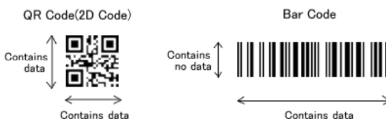
Figura 7.2. Diferencia entre almacenaje de datos entre QR y código de barras (34)
