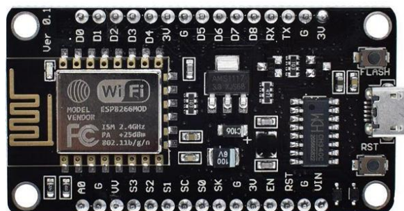
Figura 4.4. Placa de desarrollo que integra el módulo ESP8266MOD (15)
