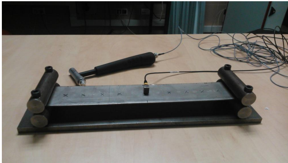
Imagen 14.- Setup de la viga de acero con acelerómetro
