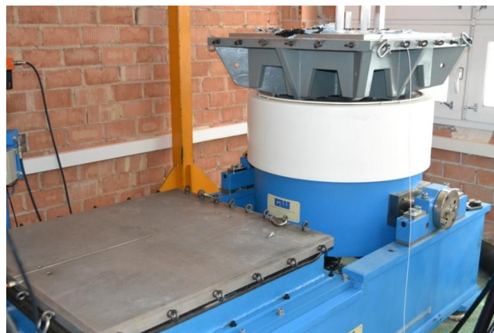
Imagen 5. - Shaker V2664 durante ensayo en laboratorio
