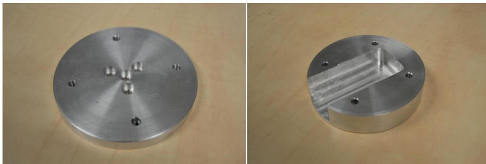
Imagen 11.- Base y sujeción superior de la mordaza
