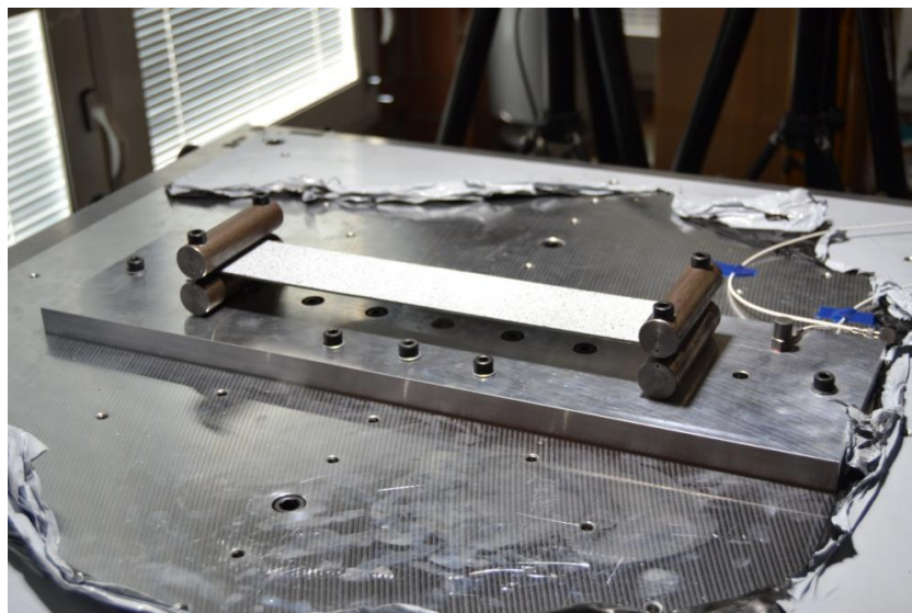
Imagen 16.- Base anclada al cabezal del shaker
