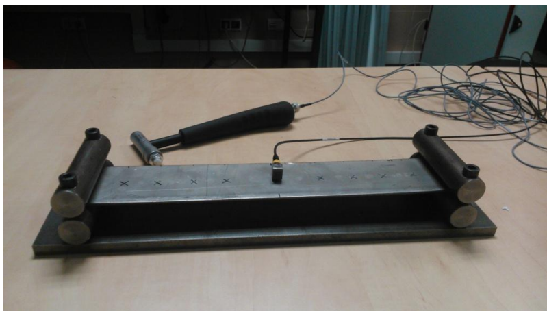
Figura 3.- Distribución de nodos equiespaciados sobre viga de acero
