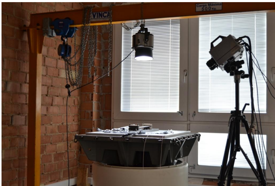
Imagen 18.- Posición del foco durante el ensayo con DIC
