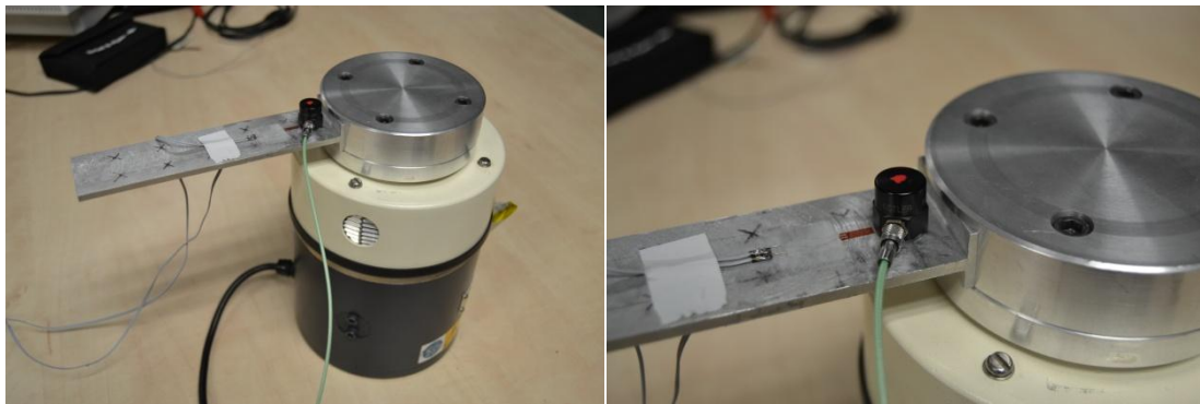
Imagen 12.- Posición del acelerómetro en viga empotrada
