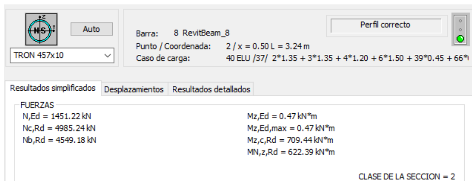
Figura 11.48. Resumen de los esfuerzos de cálculo de la viga arco. Fuente: Robot
