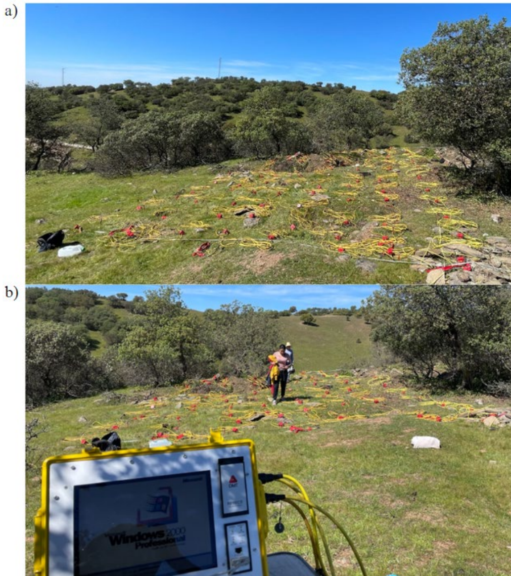
Figura. 3.29. a) Distribución y conexión de electrodos en el terreno de estudio para el día 3. b) Introducción de parámetros de estudio en el tomógrafo para el día 3.
