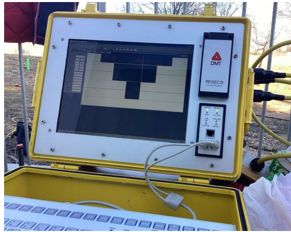
Figura. 3.16. Vista de la pantalla del ordenador en donde se muestran de manera gráfica las resistividades aparentes.
