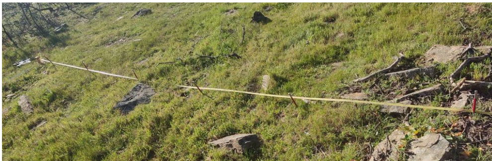
Figura. 3.26. Tensión de cinta métrica para comprobación de alineación de los electrodos.
