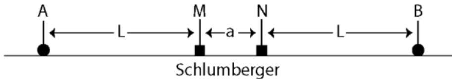
Figura. 2.5. Dispositivo Schlumberger. (Olona, Fernández, López, & Llana, 2016).
