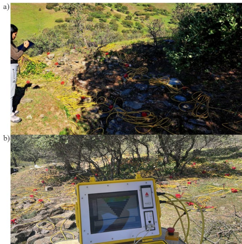
Figura. 3.30. a) Distribución y conexión de electrodos en el terreno de estudio para el día 4. b) Introducción de parámetros de estudio en el tomógrafo para el día 4.
