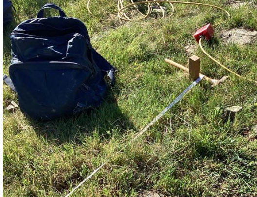
Figura. 3.25. Colocación de cinta métrica para medir la distancia entre estacas.
