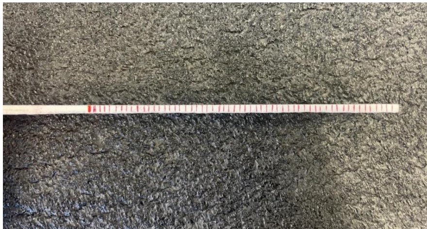
Figura 110. Marcas realizadas a las probetas para monitorizar el avance de grieta.
