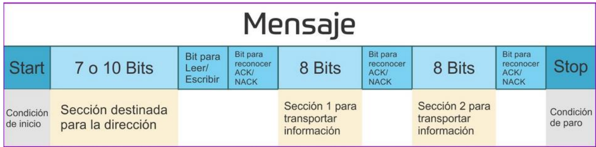
Figura 3 Composición mensaje I2C.
