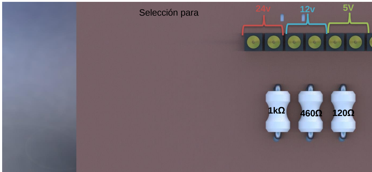
Figura 22 PCB entradas: Elementos de acondicionamiento de señal de una sola entrada.
